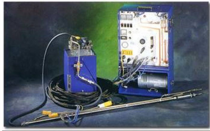
Figura 2. Muestreador de chimenea MST (Manual Sampling Train) marca Andersen Instruments Inc.
